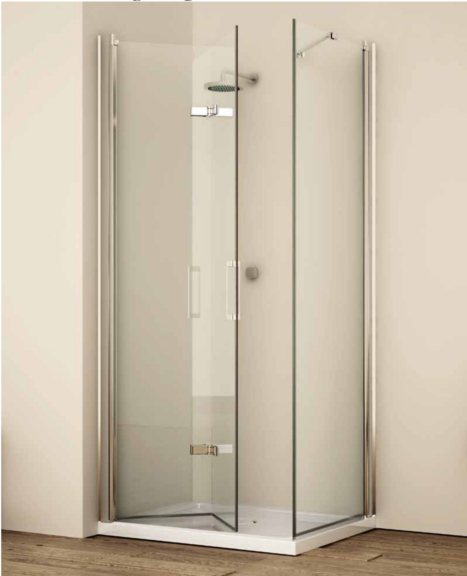
Angolo a 1 anta, 1 lato fisso e 1 porta apribile verso l'interno/esterno. Apertura ad anta ripiegabile grazie a cerniere sollevabili e snodate con cristallo da 6 mm.
