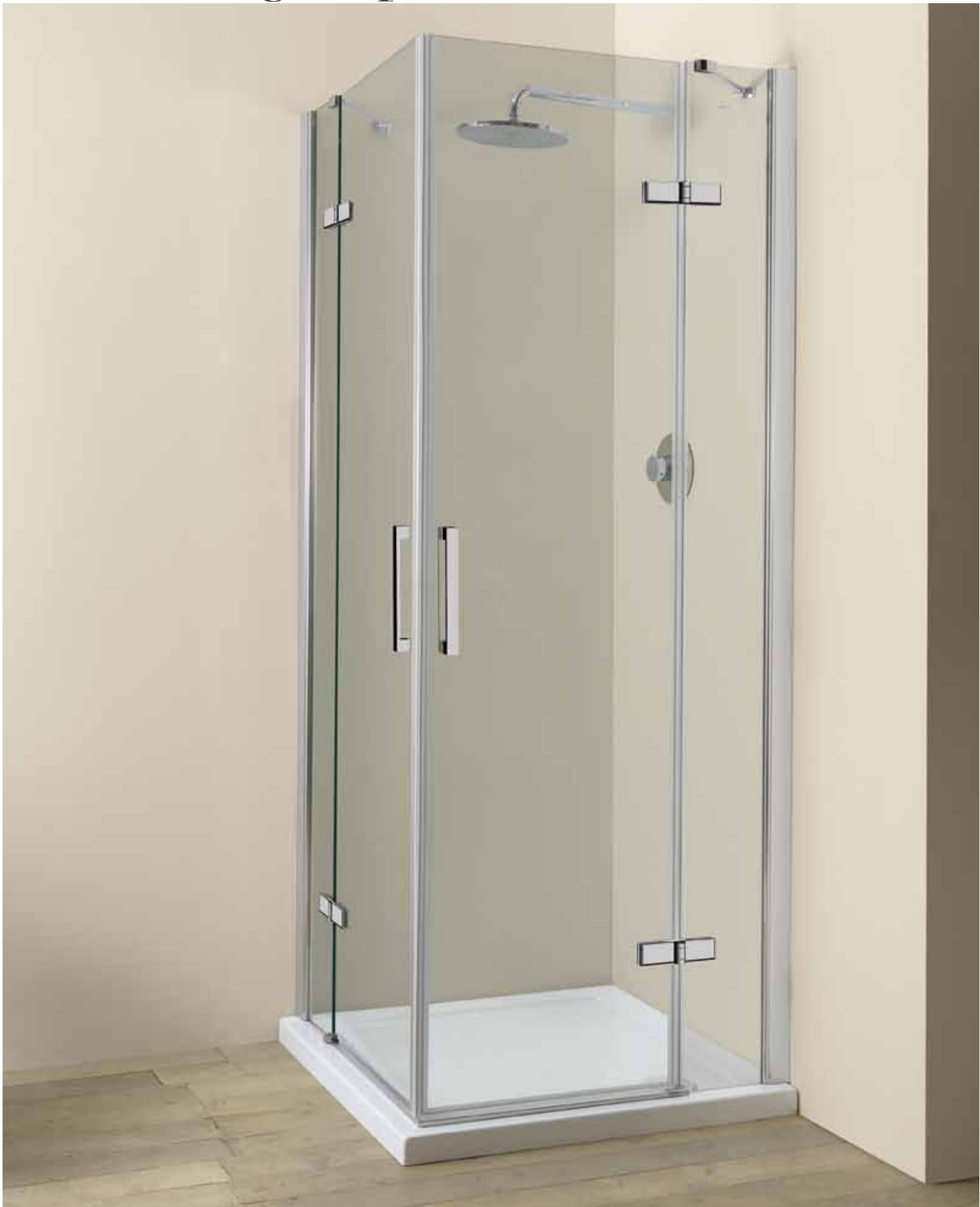
Angolo a 2 ante, 2 pareti fisse e 2 battenti con cristallo da 6 mm, apribili grazie a cerniere snodate verso l'esterno.
